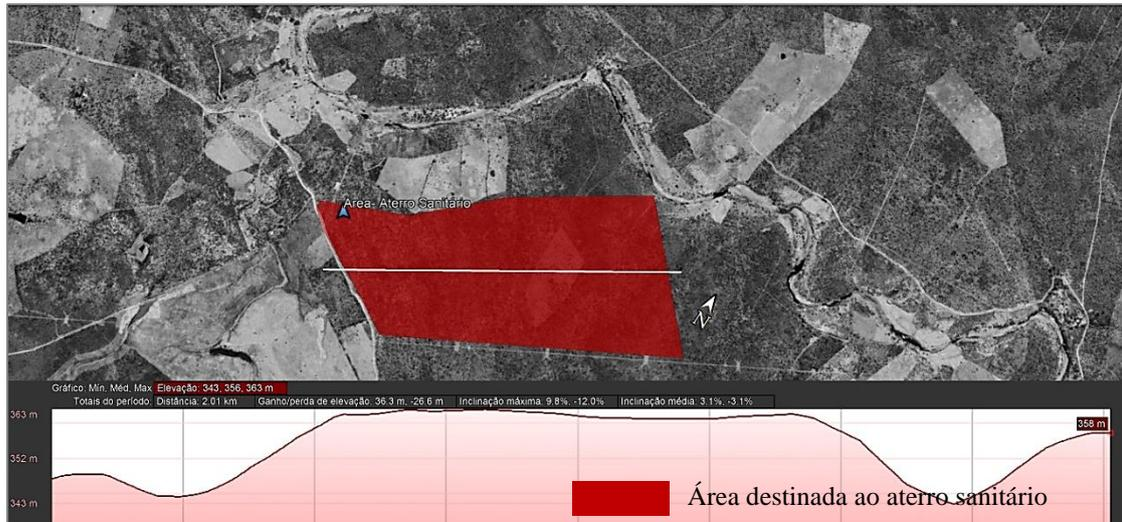
Fonte: Levantamento topográfico de nivelamento da área do aterro sanitário 01. Google Earth. Adaptada por Jéssica Monteiro, 10 de outubro de 2022.
