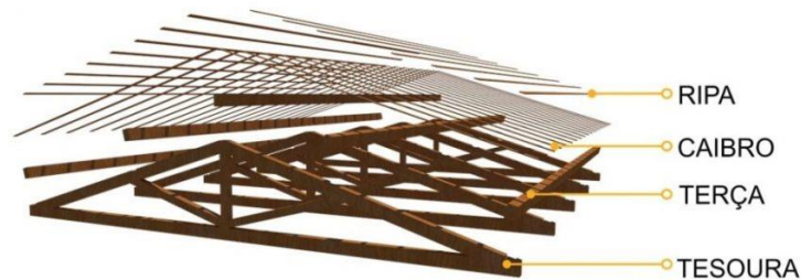
Figura 60 – Partes de um telhado
