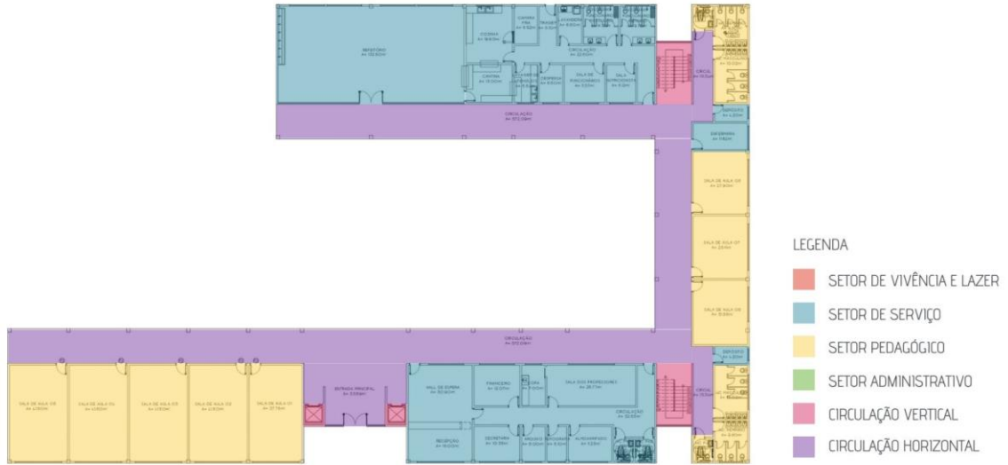
Figura 74 – Setorização do pavimento térreo
