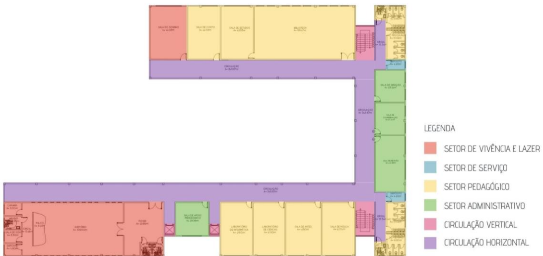
Figura 75 – Setorização do pavimento superior
