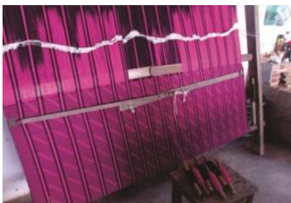
Figura 13: Rede Catada no Tear de Parede
