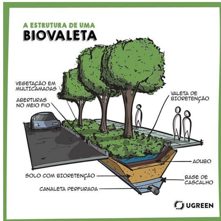
Figura 06: Estrutura de uma biovaleta
